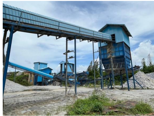
ติดตั้งอุปกรณ์ปิดคลุมสายพานลำเลียง
